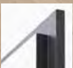
Der besondere Türfalz überdeckt die Zargenbekleidung.
